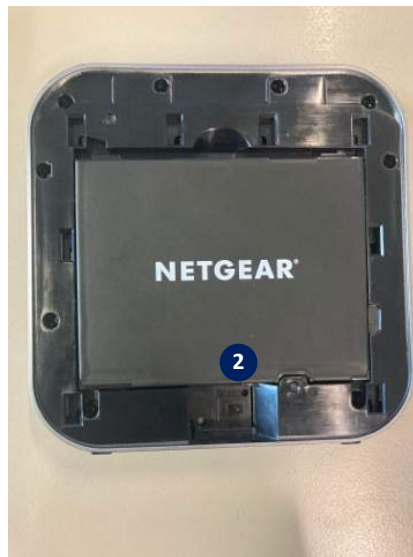
2 Appuyer sur le bouton « Reset » pendant 10 secondes
